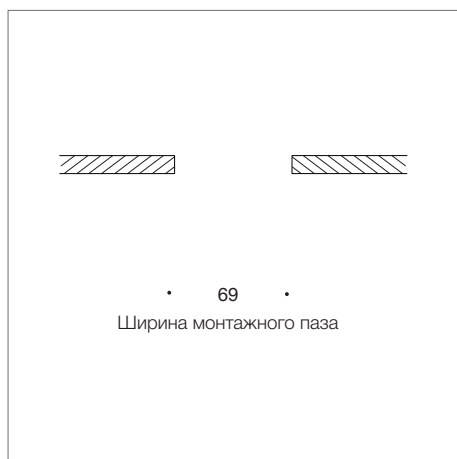
1 Подготовьте монтажное отверстие
